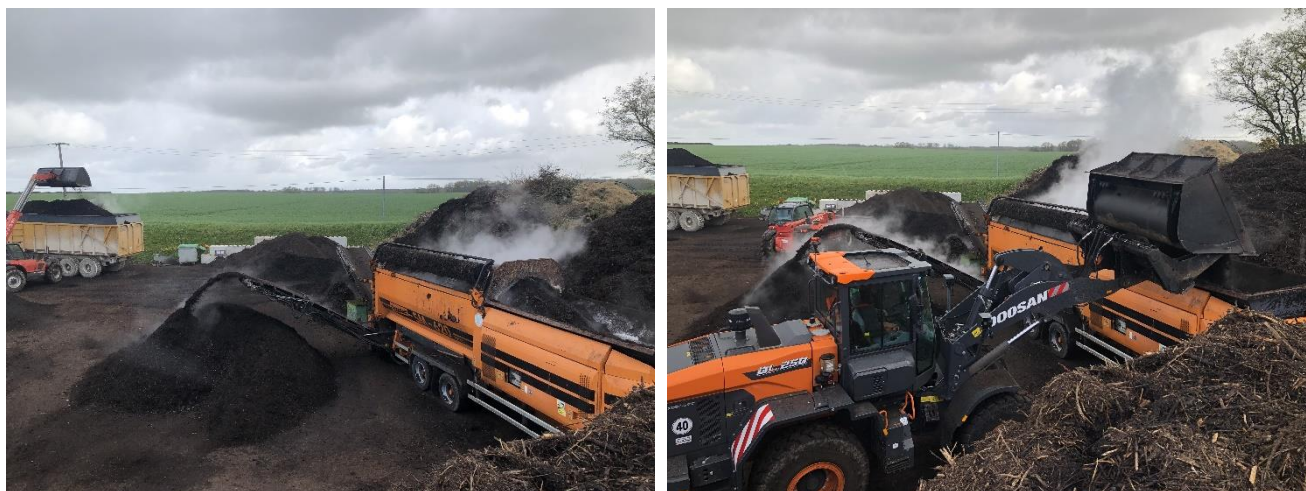
Figure 5 : Session de criblage d'un andain de DV sur la plateforme de Heugnes
