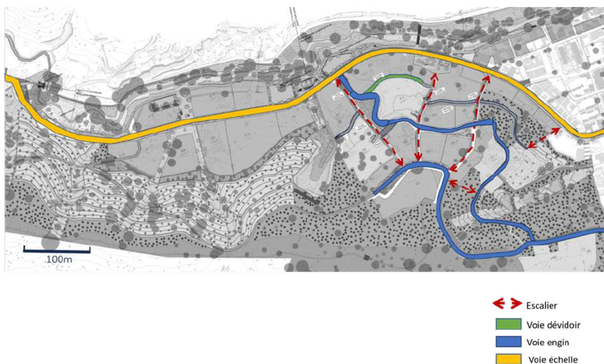
Figure 13 : Plan synthèse des voies pour la défense d'incendie de la ZAC de Doujani. Source : SCE
