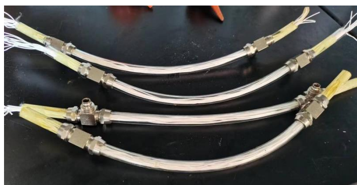
Figure 1. Module de membrane de séparation constitué de la membrane Janus (BA Deerhe, DICP, 25/06/2023)
