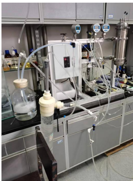
Figure 3. Dispositif de stripping simulé (Tour de soufflage, pompe à eau, membrane de séparation Janus, bouteille de stockage d'eau) (BA Deerhe, DICP, 27/06/2023)
