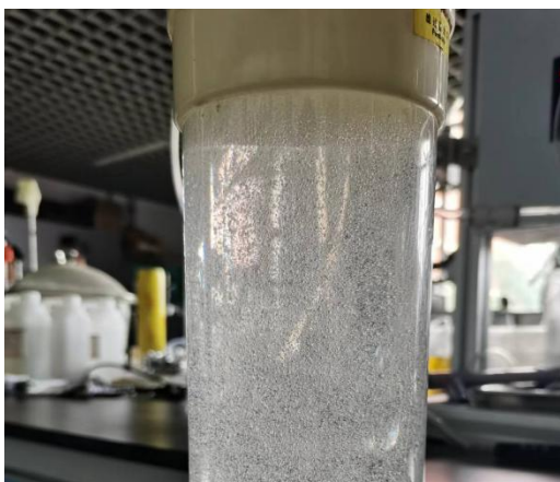
Figure 2. Micro bulles dans la tour de stripping (BA Deerhe, DICP, 05/07/2023)
