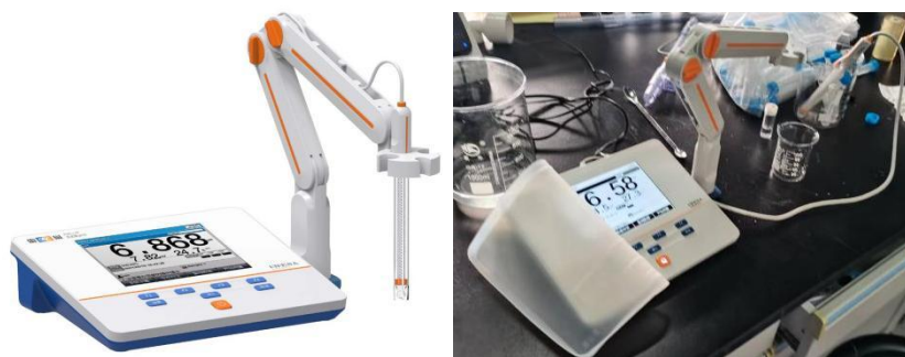
Figure 6. Shanghai Leici Instrument Co., Ltd. PHSJ-3F PH-mètre de laboratoire ( https://www.lei-ci.com/ , 05/07/2023)(BA Deerhe, DICP, 05/07/2023)
