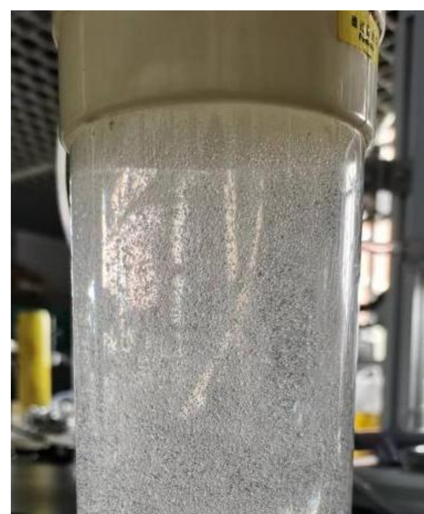
Microbulles dans une petite tour de réaction (BA Deerhe, DICP)
