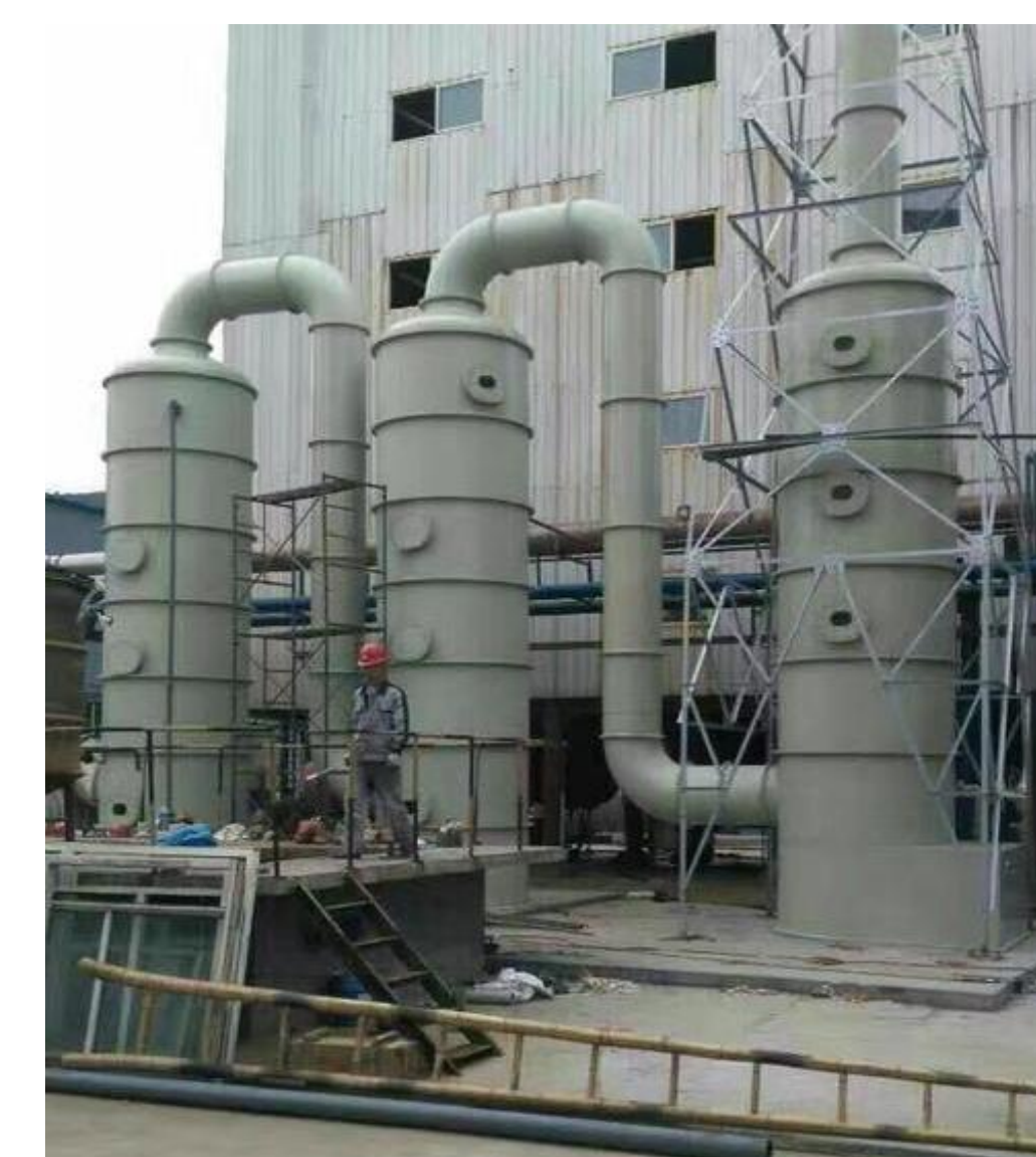
Tour de stripping industrielle à l'azote ammoniacal et petite tour de simulation (BA Deerhe, Wuxi usine chimique et DICP)
