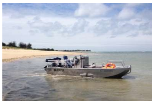
Figure 17. Navette hydrographique pour la bathymétrie
