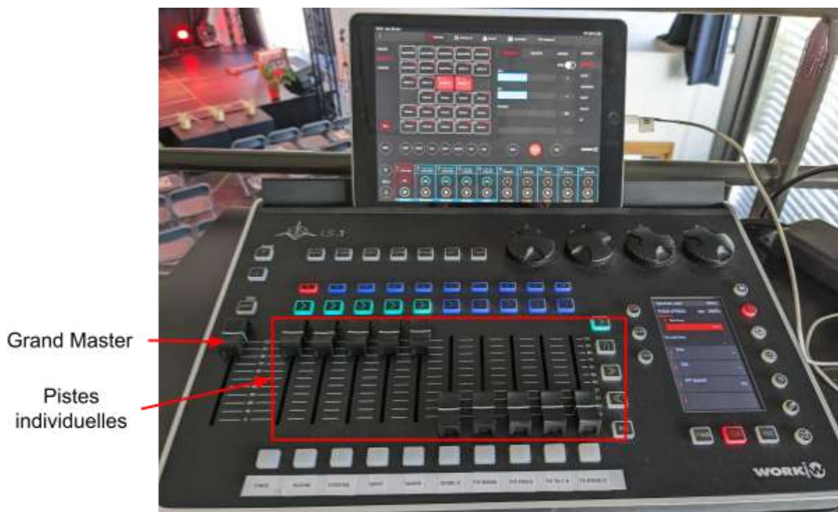
Figure 21 : La console et la tablette permettant de contrôler l'éclairage de la scène d'Arkopol. (Léna Mélédo)
