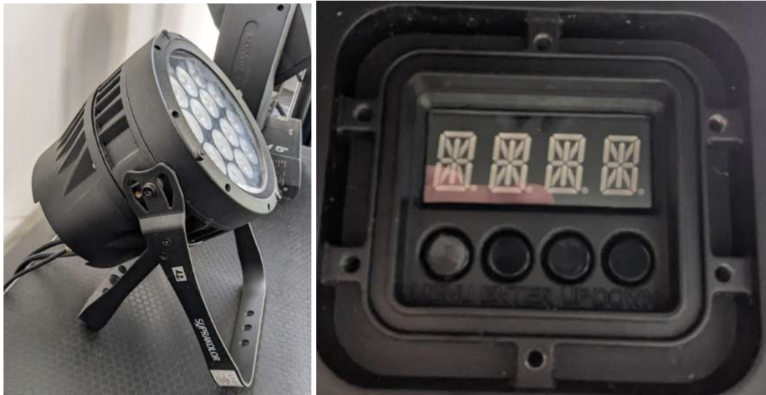
Figure 19 : Un projecteur SupraKolor de Starway et son boîtier de pilotage situé à l'arrière (Léna Mélédo)
