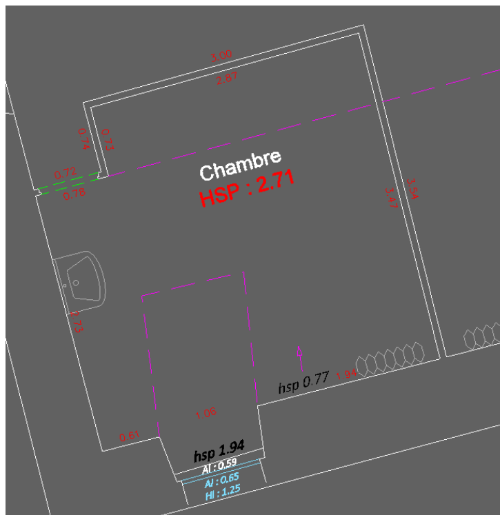
Exemple d'utilisation de la commande cotation linéaire
