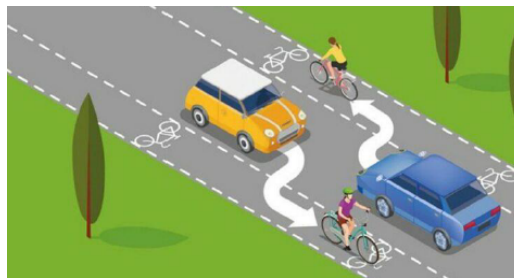
Figure 18 : Illustration d'une CVCB et de son principe de circulation. Source :
