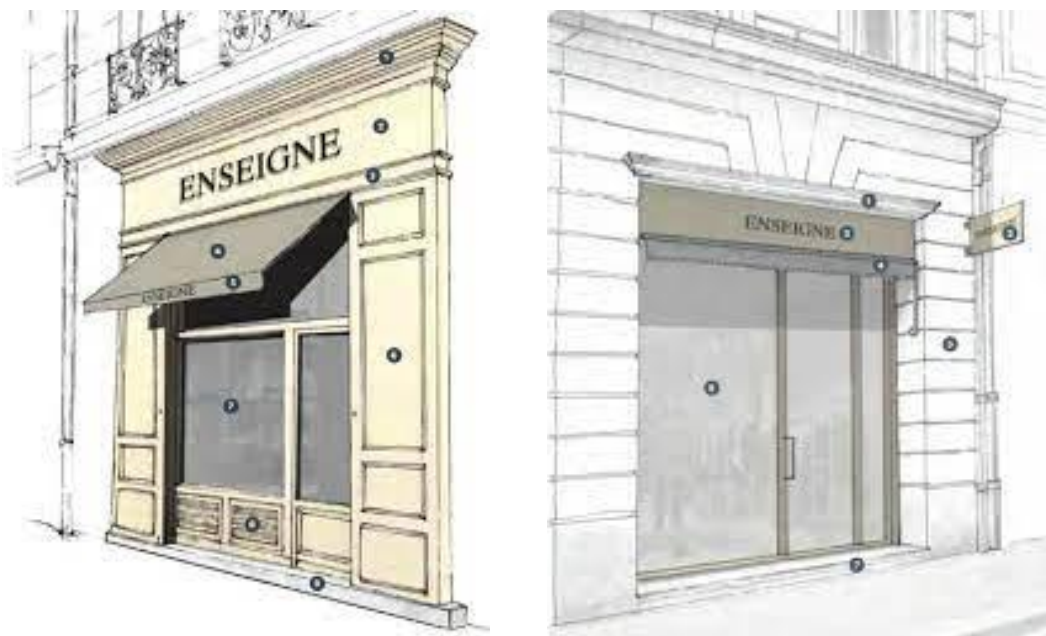
Figures 3 et 4 : Devanture en applique et devanture en feuillure (gauche : Devanture en applique, disponible sur : DRAC CORSE - Direction Régionale des Affaires Culturelles de Corse ; Droite : Devanture en feuillure, disponible sur : DRAC CORSE - Direction Régionale des Affaires Culturelles de Corse )
