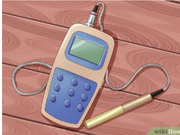
Figure 8: Schéma d'un conductimètre électronique avec sa sonde (WikiHow, n.d.)
