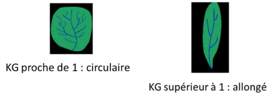
Figure 4 - Le coefficient de compacité de Gravelius expliqué en schémas (Source : Séraphine GRELLIER)
