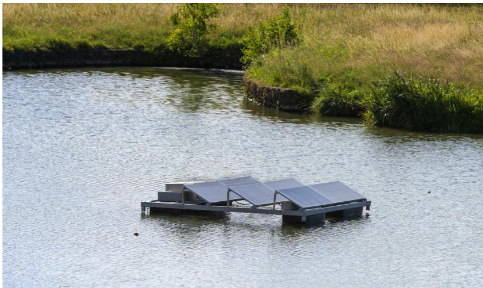
Figure 17: la plateforme de purification solaire (Source : https://www.saint-quentin-en-yvelines.fr/fr/actualites/une-solution-innovante-pour-la-gestion-des-milieux-aquatiques-23291 )
