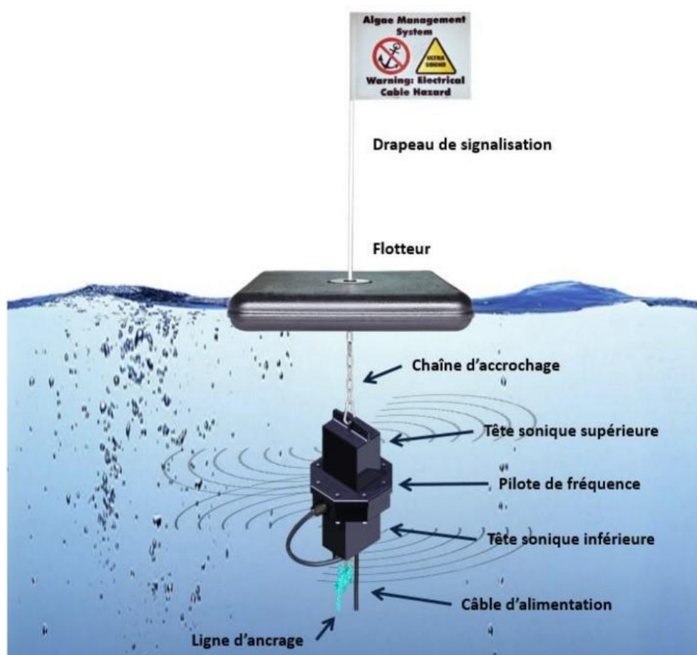
Figure 13: Schéma de construction de l'équipement utilisé dans la méthode des ultrasons (Source : https://www.rt78.fr/actualites/cyanobox )
