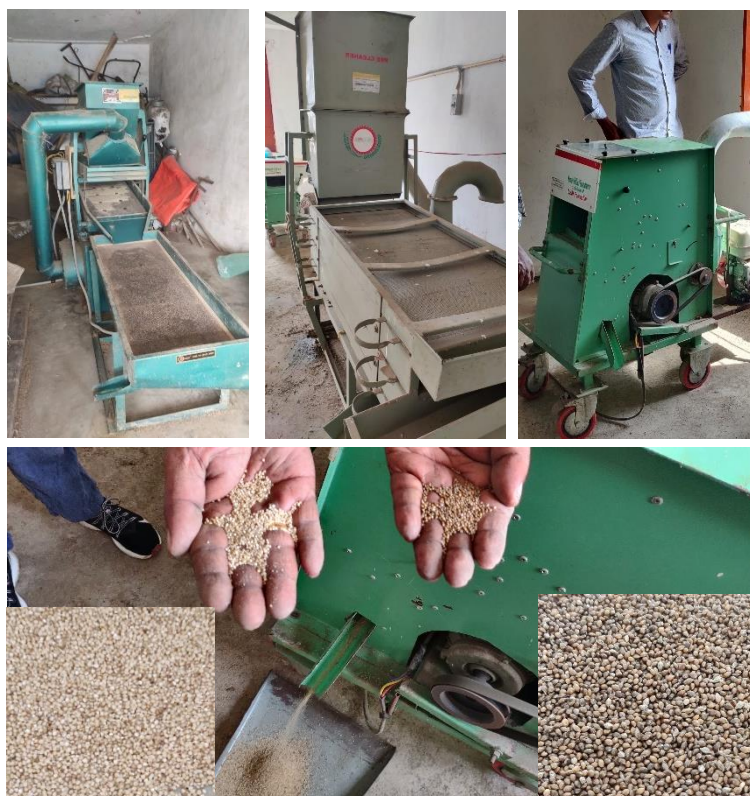
Machines créées par la DHAN pour la transformation du millet brut (sombre) en riz de millet (clair) (Source : Tatiana Charié)
