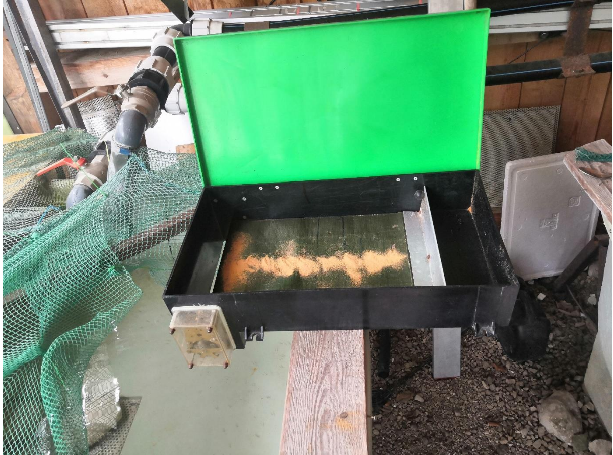
Figure 24 : Mise en place de la machine à nourriture (tombant petit à petit sur la gauche dans l'eau)
