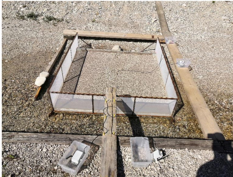
Figure 33 : Répartition latérale des capteurs au centre du mésocosme
