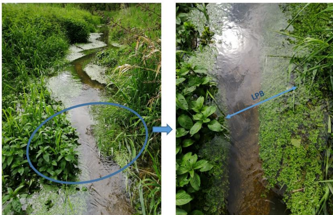
Figure 11 : Illustration de la mesure de largeur plein bord
