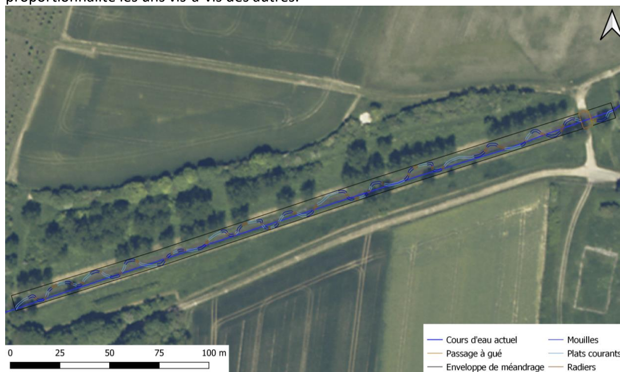
Figure 33 : Cartographie du profil en long du projet de reméandrage
