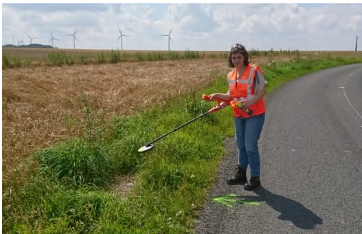
Figure n°29 : Détection de chambre sur le projet Nord-Pas-de-Calais en sortie terrain
