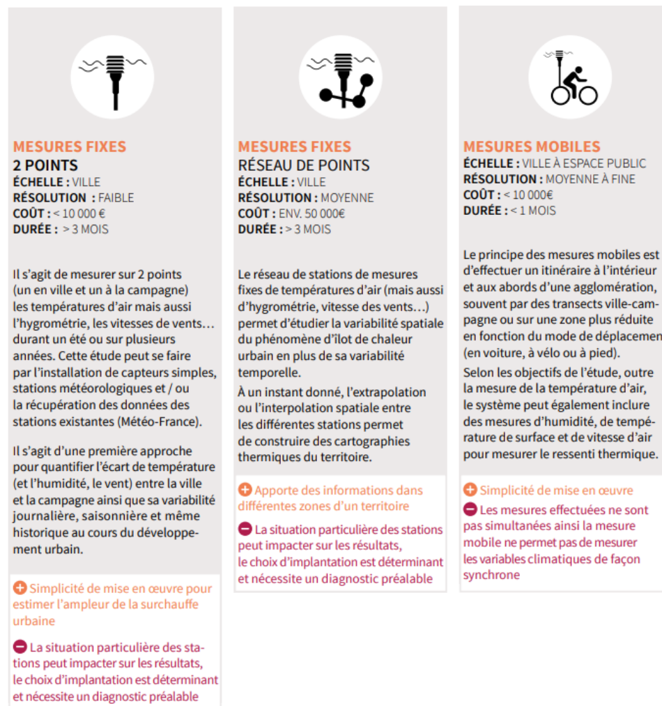
Figure 6 - Méthodes de mesure d'air pour le diagnostic des ICU, source : ADEME
