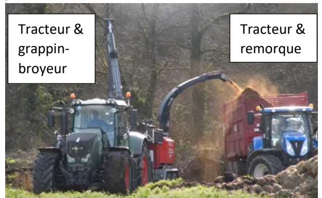
Figure 2 : Rôle des deux tracteurs de front utilisés pour le broyage du bois en plaquettes. Source : CUMA du Morbihan
