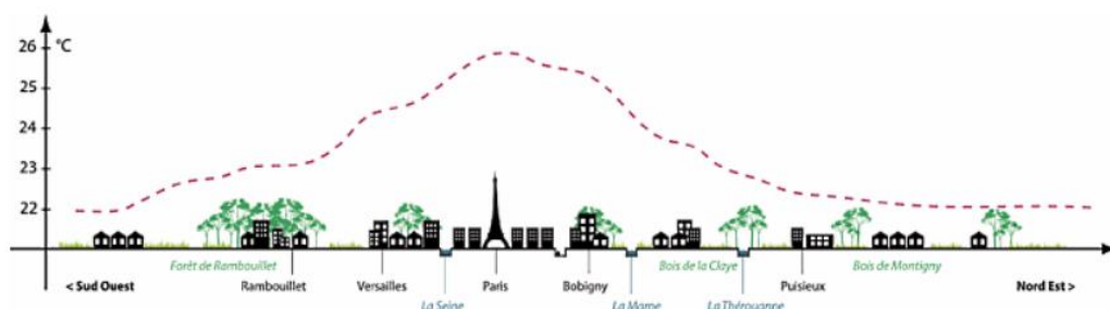
Figure 4 : Coupe schématique de visualisation des températures en 2008 pour une nuit de canicule (type été 2003) Source : ©Groupe DESCARTES – Consultation internationale de recherche et de développement sur le grand pari de l'agglomération parisienne, 02/2009
