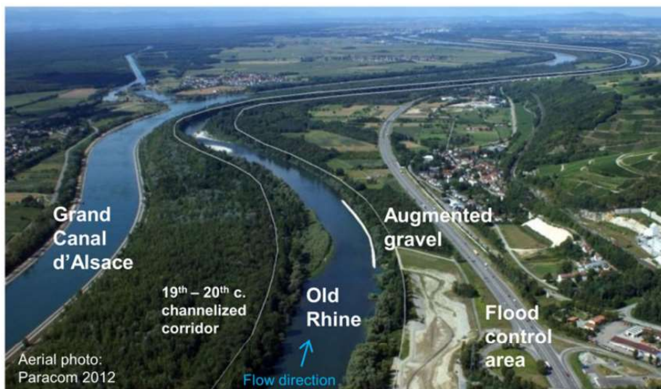
Figure 2 : Zone de recharge sédimentaire sur le Vieux-Rhin. A gauche, le canal de dérivation (Grand Canal d'Alsace). A droite, le Vieux-Rhin court-circuité dans lequel a lieu la recharge sédimentaire (Arnaud et al., 2017).
