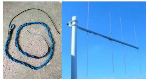
Figure 3 : Antennes radio, subaquatique (à gauche) et aérienne de type Yagi (à droite)
