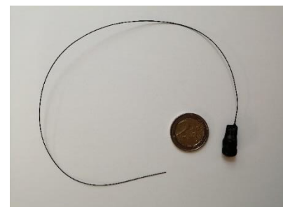
Figure 4 : Emetteur radio, comparé à une pièce de 2€
