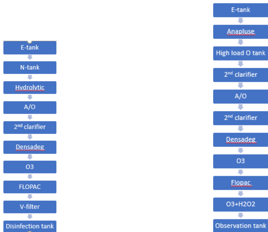
Figure 16 & 17, Le processus de traitement de l'eau de LOW TDS & HIGH TDS
