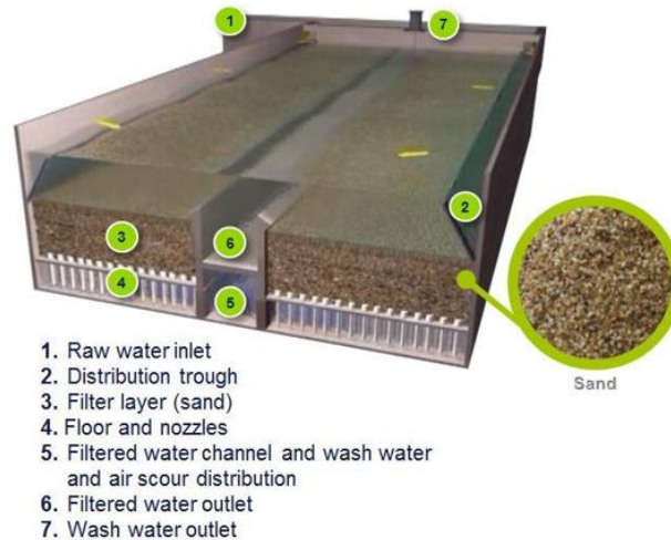
Figure 9, La structure de V Filtre
