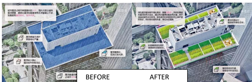
Figure 10, toiture végétale (Shengsheng)
