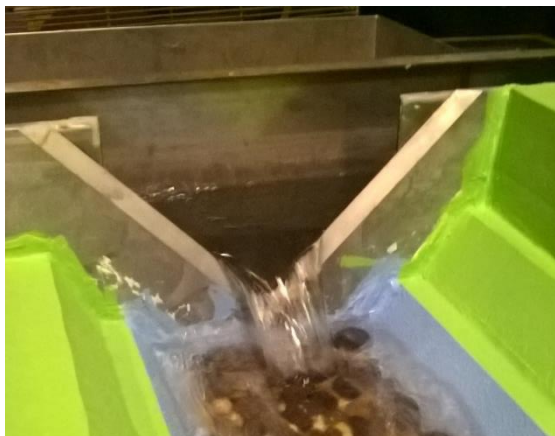
Figure 3 : Déversoir en V
