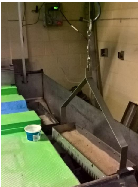
Figure 10 : Système de récupération et de pesée discontinue du débit sortant sur un modèle physique
