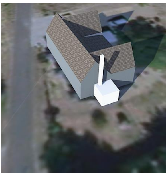
Ajout d'un double garage en extension de la maison. Le garage est surélevé pour répondre aux exigences du PPRI
