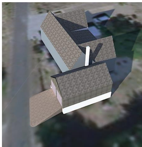
Ajout d'un double garage en extension de la maison. Le garage est surélevé pour répondre aux exigences du PPRI
