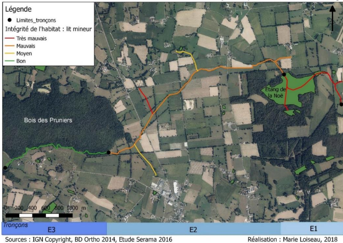
Figure 8 : Vue aérienne du Ruisseau de l'Etang et données sur l'intégrité du lit mineur (Serama, 2016d)
