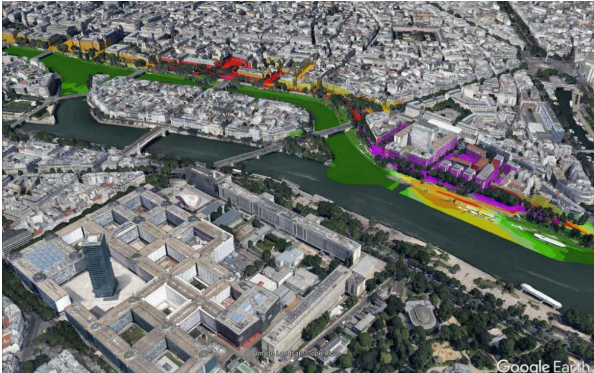
Figure 9 Evolution de la contribution sonore LA_{eq}(22-6h) des voies considérées sur la période nocturne en vue 3D – du Pont d'Arcole au Port de l'Arsenal -Bruitparif
