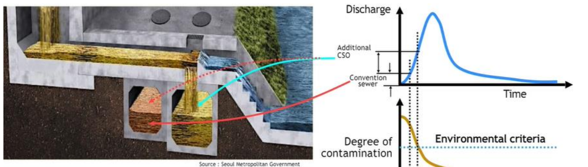
Figure 28 Protection du cours d'eau vis à vis des ruissellements pollués - Myunggu - Seoul Metropolitan Government
