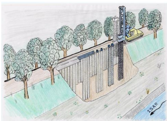
Figure 6 : Schéma du renfort des digues au moyen d'un diaphragme étanche. Source : State Office for Water Management Munich.
