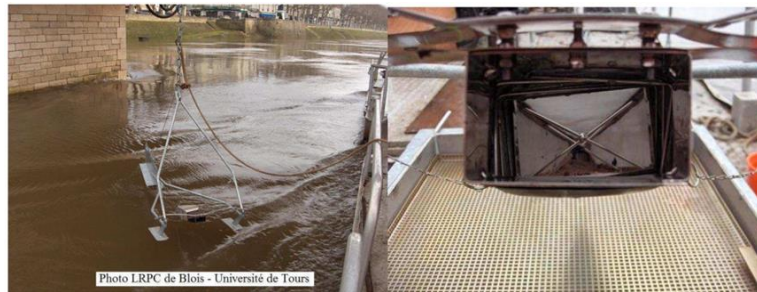
Figure 10 : Déploiement du BTMA et récupération de l'échantillon (CETMEF, 2011)
