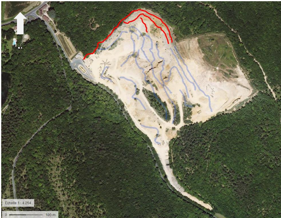
Fig. 6 : Les modifications apportées aux fronts de taille de la carrière de Campagne
