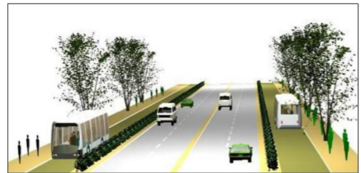
Figure 48 : Vue d'un site propre bilatéral Source : Systra 2014
