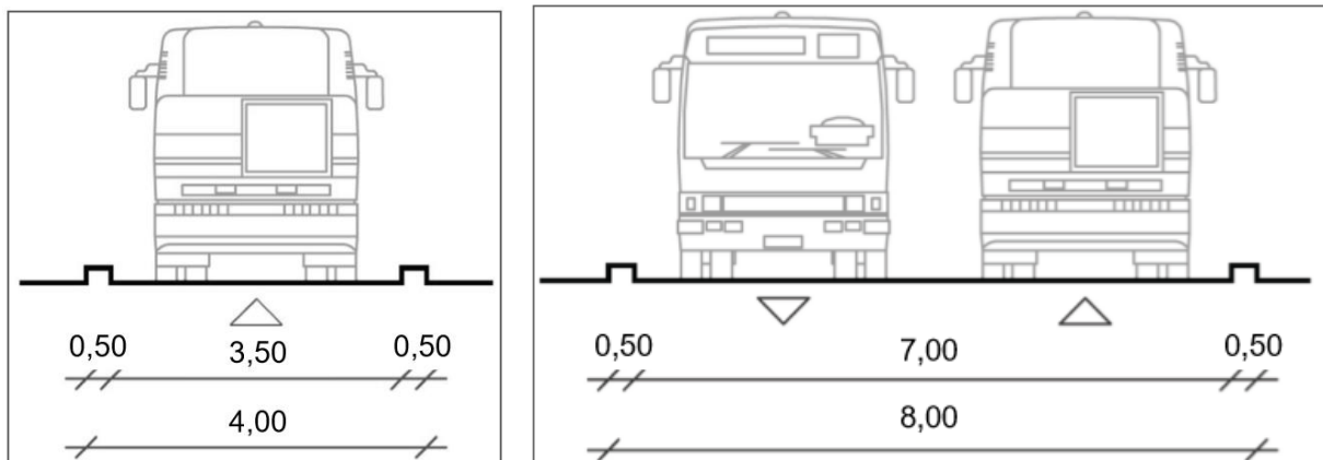
Figure 47 : Cheminement BHNS voie unique et voie double Source : Systra 2014
