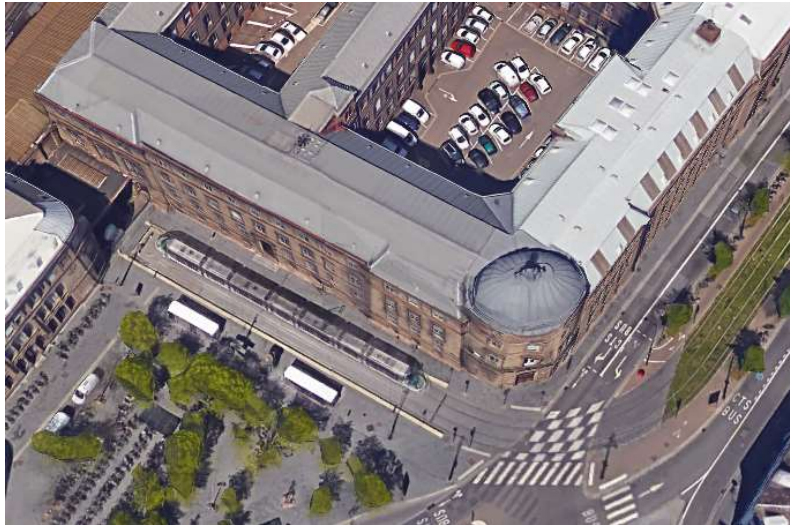
Vue aérienne 13 : Terminus en cul de sac : gare de Strasbourg (source : Google Earth)
