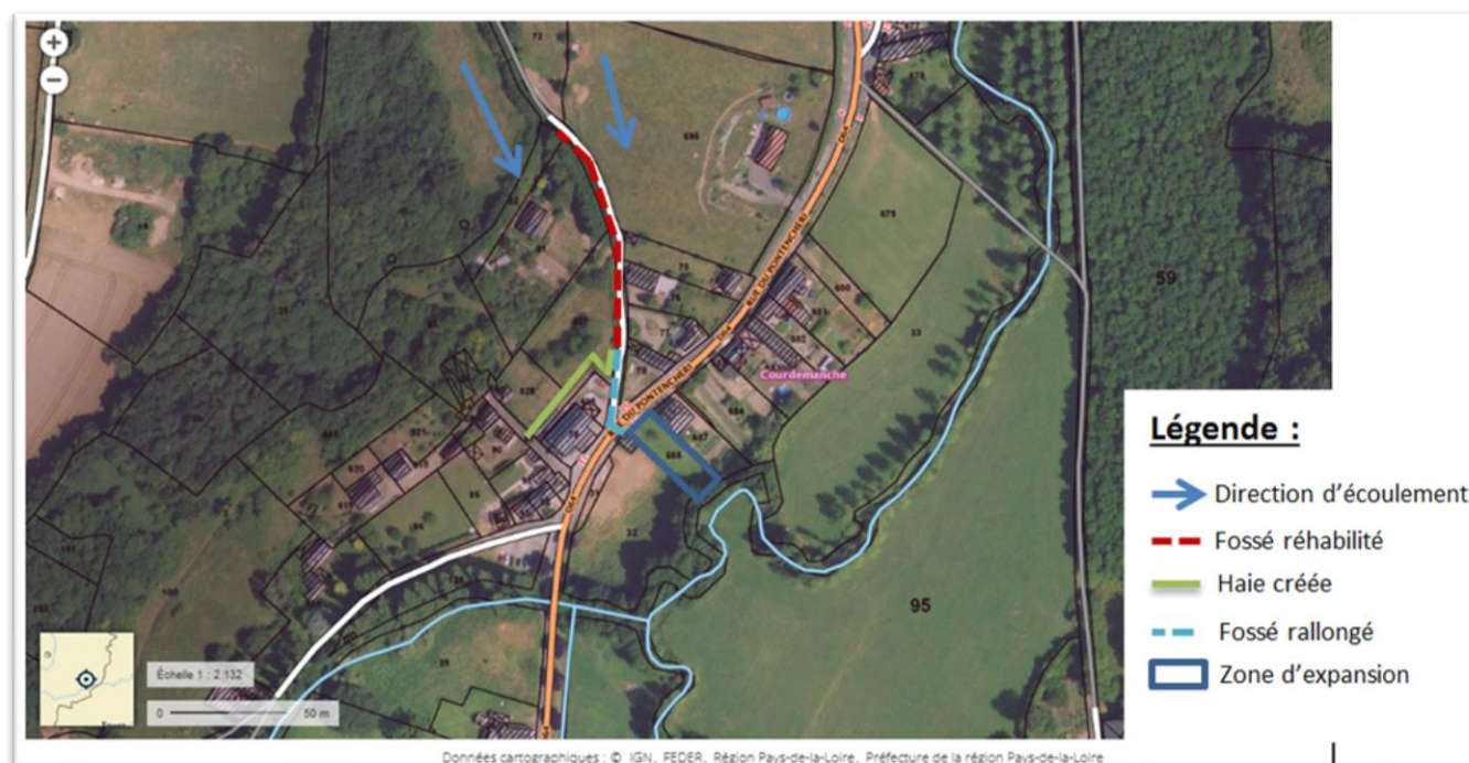
Figure 32 : Schéma d'aménagement du Lieu-dit Pontcherie (Source :A.Joubert)
