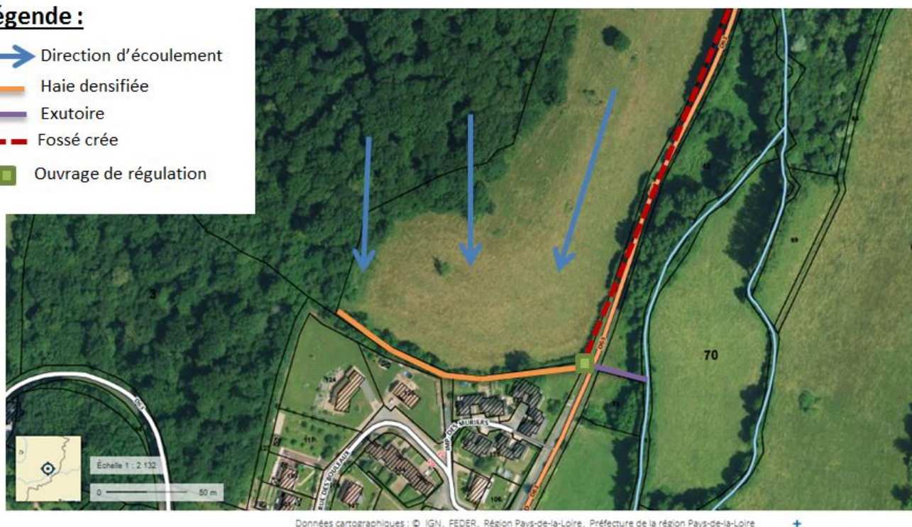
Figure 31 : Schéma d'aménagement du Lieu-dit Roibeau(2)
