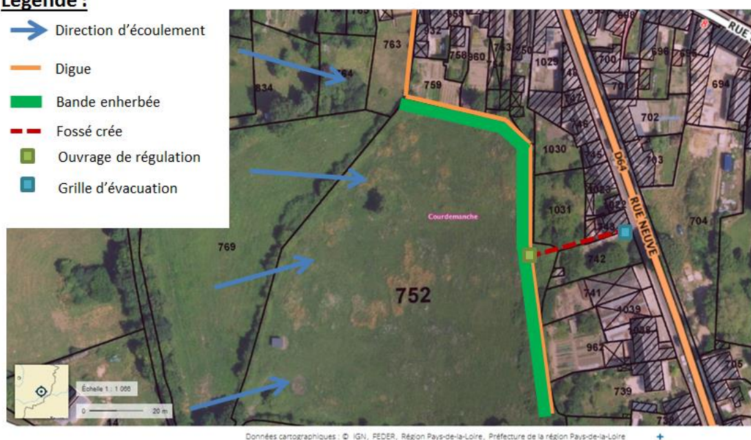
Figure 30 : Schéma d'aménagement du Lieu-dit Aurore (Source : A.Joubert)
