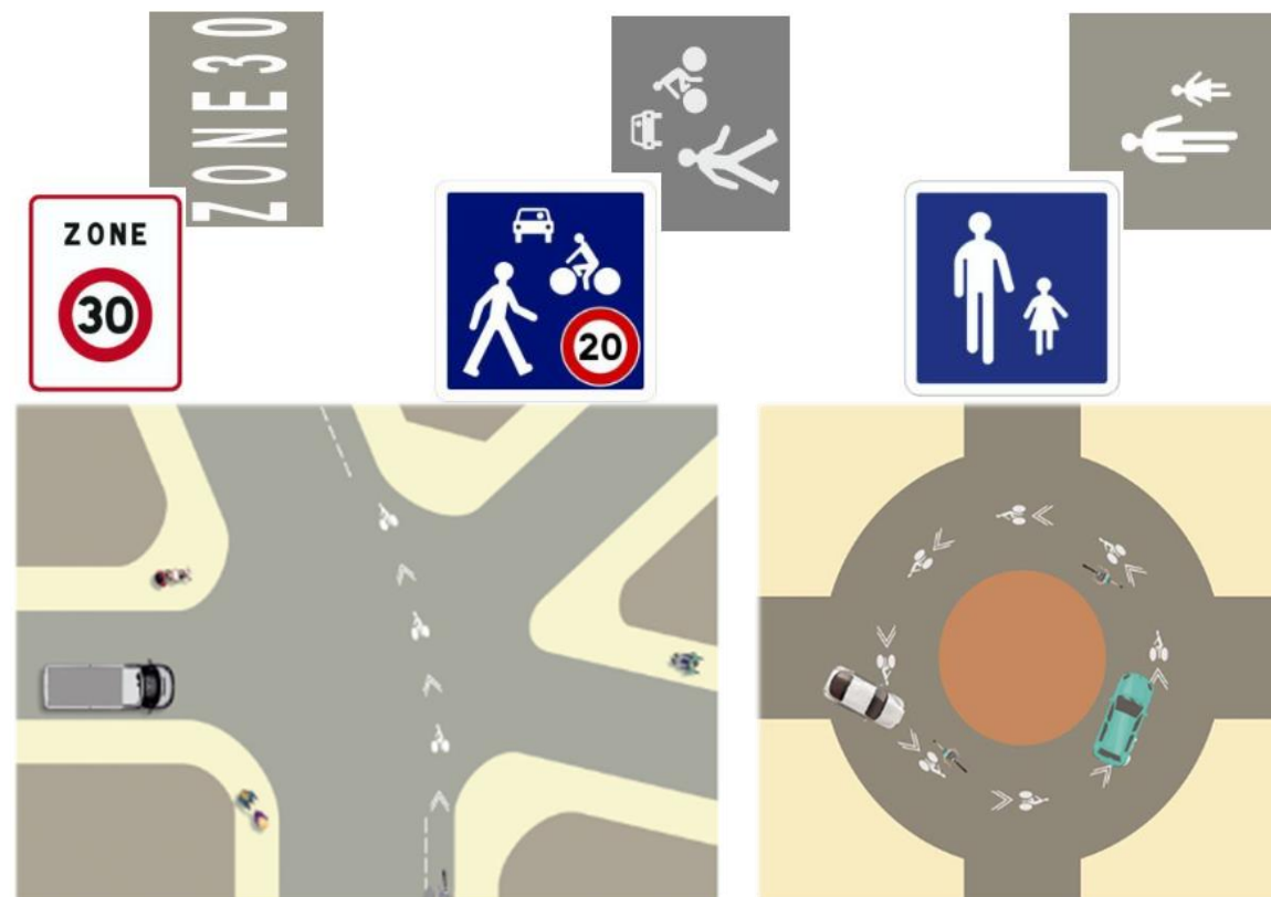
Marquage au sol (CEREMA, 2016)
