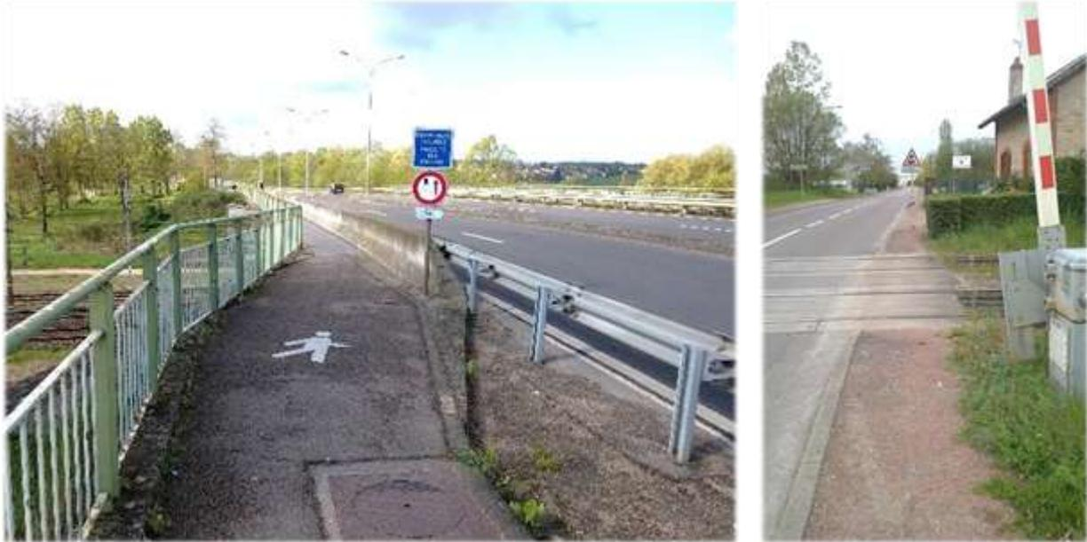
Figure 62 : Rétrécissement de la voie cyclable à cause de barrières basses sur le pont SNCF sur la rocade à Chalon-sur-Saône ou d'un panneau de la signalisation routière sur la promenade cyclable, rue ferrée (Photographie : Kévin DEBAETS & Pauline DUTHEIL)
