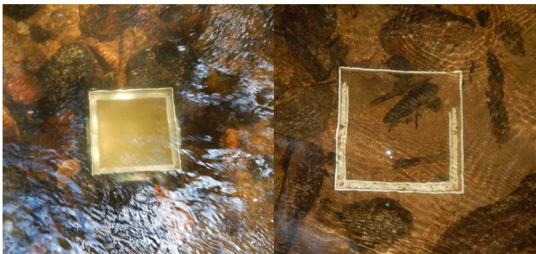
Figure 7 : Les pièges à sédiments lors de leur mise en place (gauche) puis après une crue (droite). Source : SIVOM d'Ambert.
