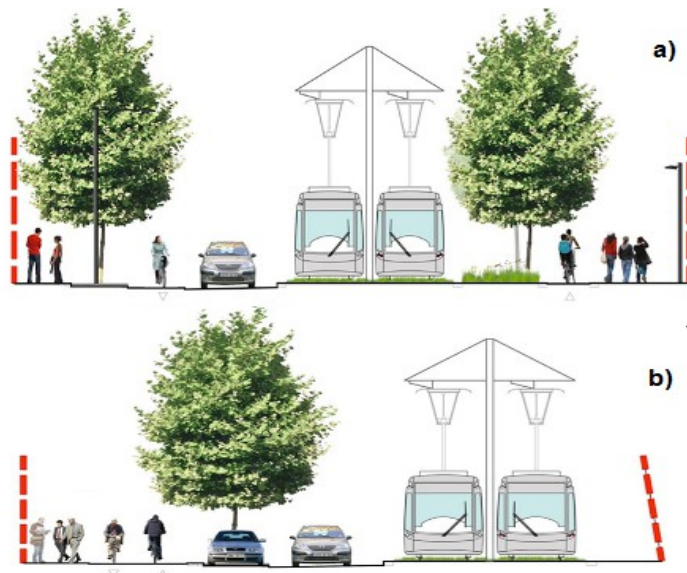
Illustration 8: Types de plateforme du tramway : a) Insertion axiale b) Insertion latérale (STIF)
