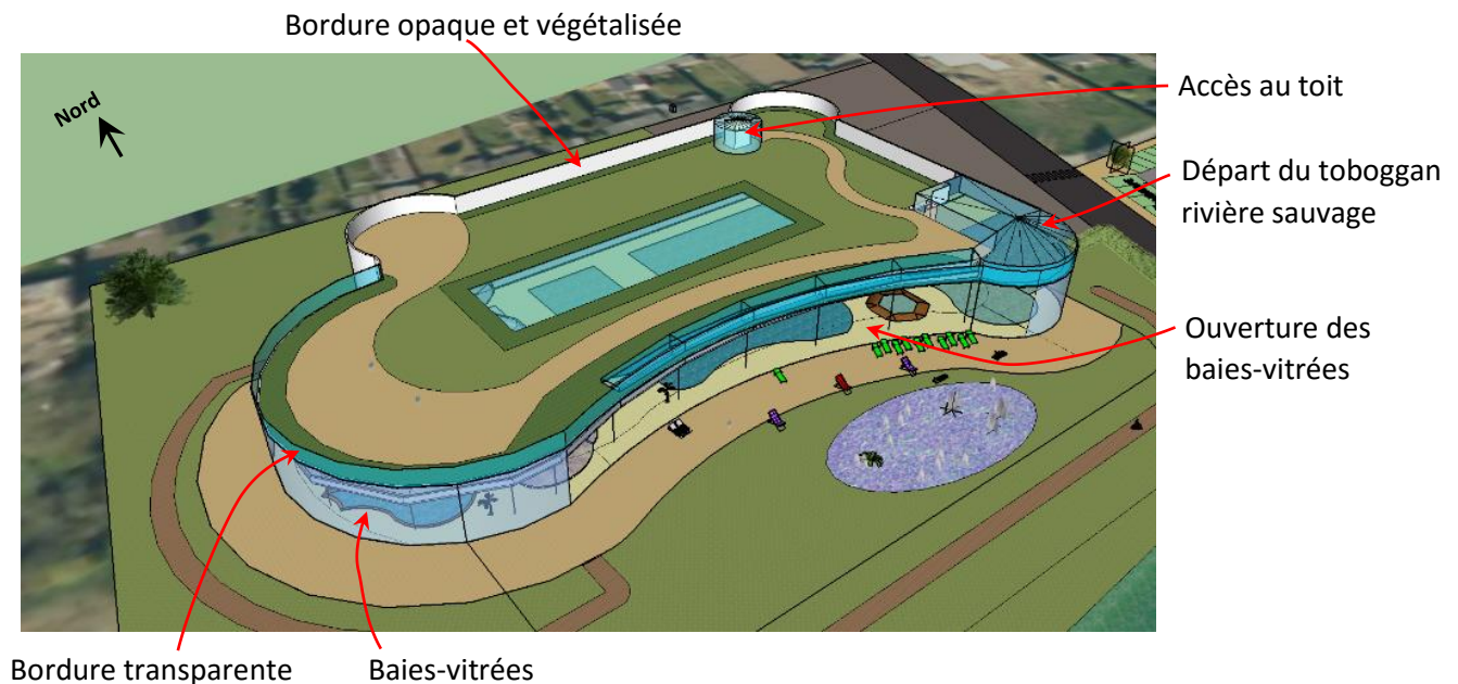
Figure 27 : Vue sur le toit et le Sud du bâtiment. (Fond de carte : Géoportail. Réalisation : MOY Yolaine, SketchUp).
