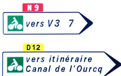
Figure 16 : Rabattement par D21a dimension 1600x400 et rabattement par D21a dimension 2200x500 (Sources : Certu, La signalisation des aménagements et itinéraires cyclables)
