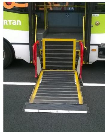
Figure 13: Plateforme d'accès au matériel roulant sur un car
