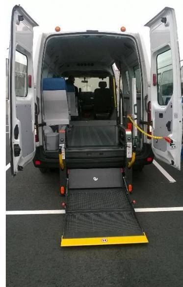
[Figure 55: Sortie de la plate-forme d'un véhicule utilisé pour le TPMR](#)
