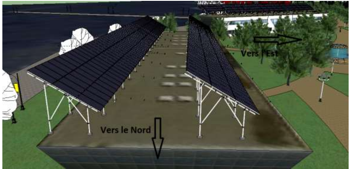
Figure 58 : Orientation panneaux solaires
