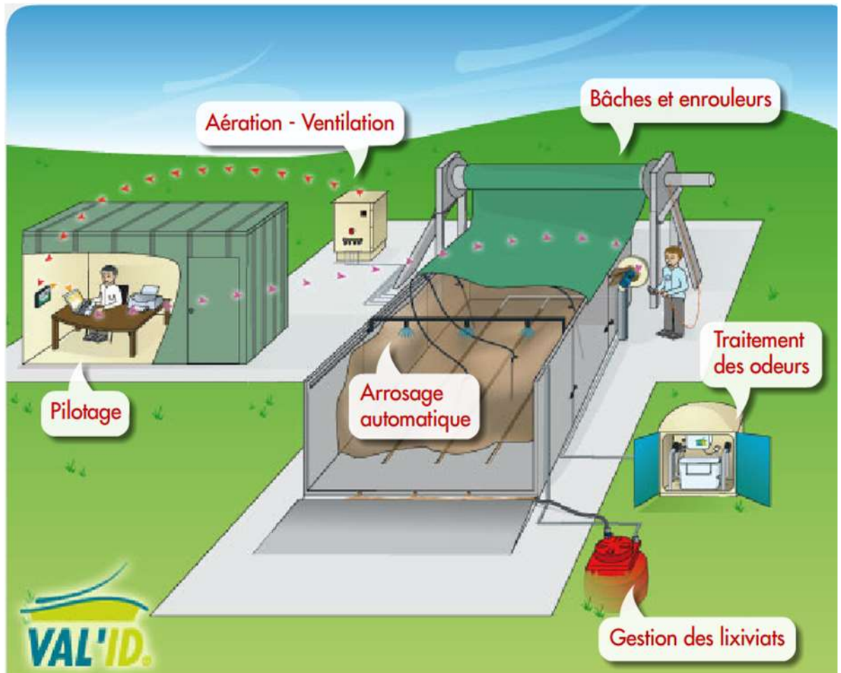
Figure 25: Représentation schématique du procédé Val'id
