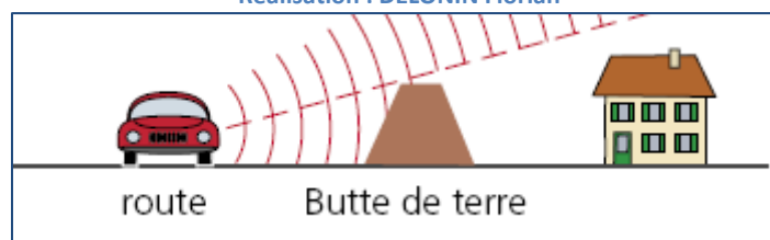
Coupe 2 et 3 : Représentation du dispositif réduisant les nuisances sonores des voies de transport
