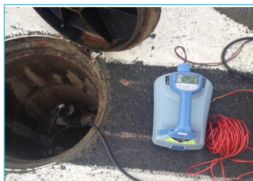
Générateur permettant la radiodétection
