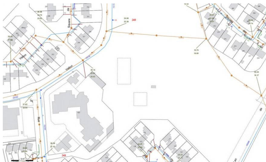
Illustration 29 : Plan du réseau d'alimentation en eau potable Source : M. MORANDEAU (Direction Eau et Assainissement)
