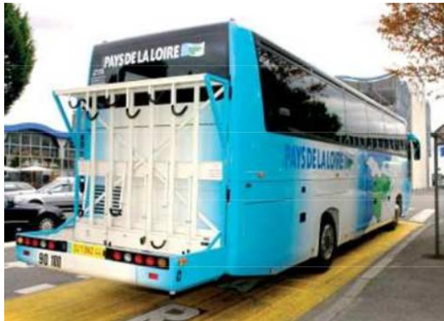
Figure 50 : Exemple d'installation de porte-vélos extérieurs
