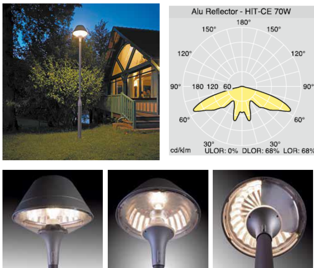
Figure 26 : Le luminaire Plurio conçu pour limiter les nuisances lumineuses. On voit sur le diagramme polaire ci-contre, traçant la courbe photométrique du luminaire, qu'il n'émet aucun flux lumineux au-dessus de l'horizontale, 0° étant la verticale du pied.
