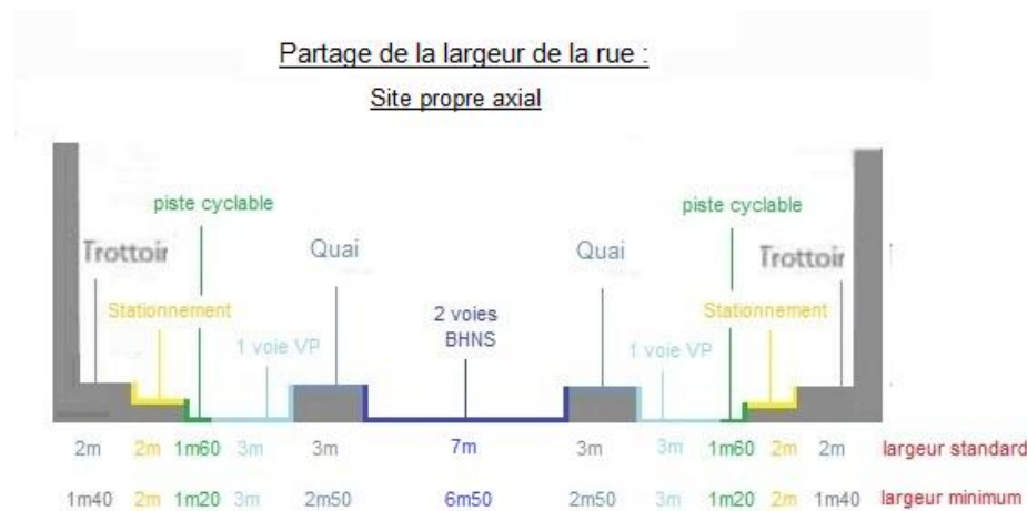
Figure 4 : Partage de la voirie : insertion axiale réalisation Ludmilla POMMIER-MOREL
