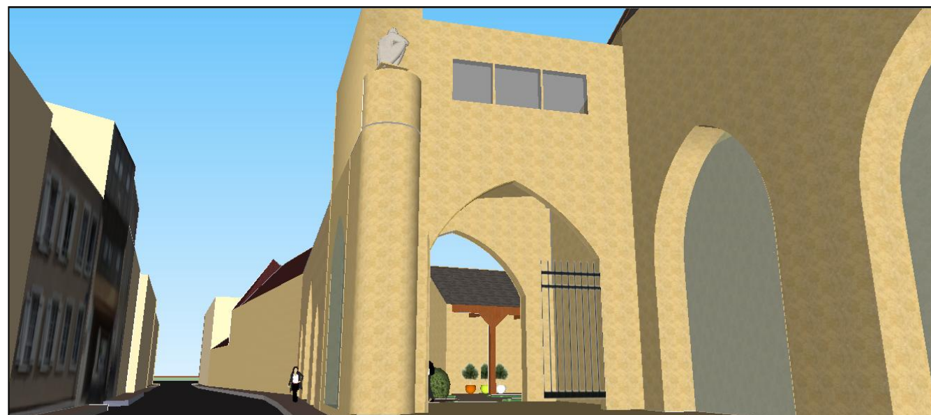
Figure 32 : Arche, permettant le passage, la réutilisation des loges à l'étage, et la création d'un escalier de secours pour la salle des Carmes (Réalisation personnelle)
