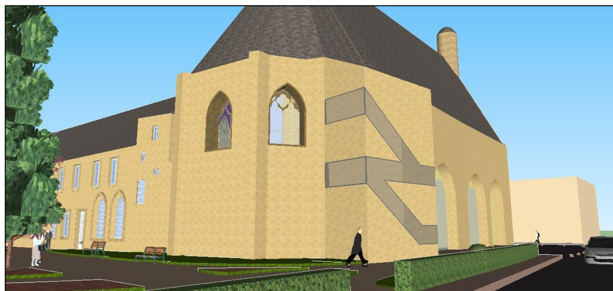
Figure 38 : Escalier de secours pour la salle des Carmes (Réalisation personnelle)
