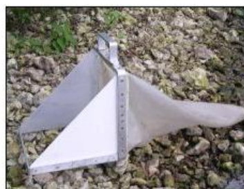
Figure 18: Matériel de prélèvement des macroinvertébrés: le filet surber ; source : truite.freeze.org et RNFA
