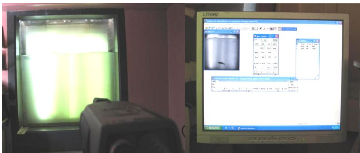
Figure 12: Station de comptage des passages à l'ascenseur. A gauche : la caméra pointée sur la vitre, à droite : l'ordinateur enregistreur de données ; source : J.Ollitraut
