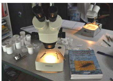
Figure 20: Matériel de détermination: pilulier, pince, loupe binoculaire et guide de détermination des invertébrés d'eau douce ; source : personnelle.
