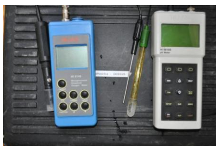
Figure 17: A gauche : l'oxymètre; a droite, le pHmètre ; source personnelle.
